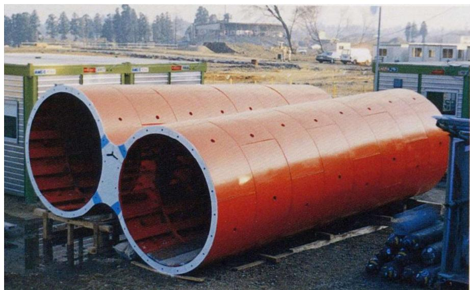
図-1.14 一体型セグメントによるスパイラルトンネル
