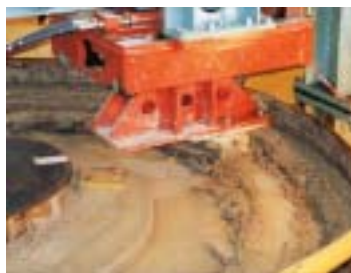
スパイクビットモルタル切削実験
