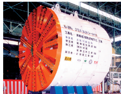
本線福島附近地下化工事の内土木第三工区工事▲ (シールド径：φ10.8m、施工延長：210m)
