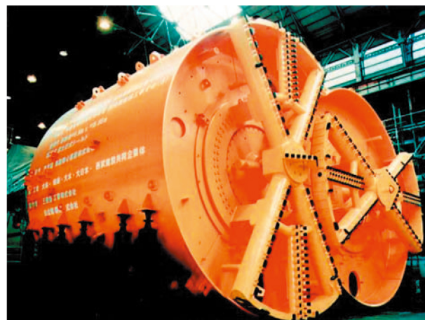
シールド外径: \phi 9.36m \times W15.86m
