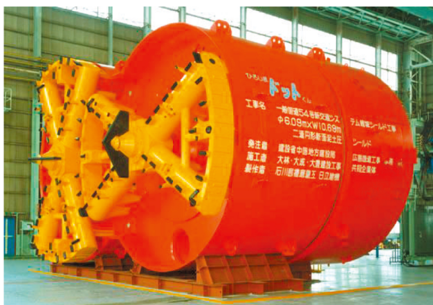
シールド外径: \phi 6.09m \times W10.69m
