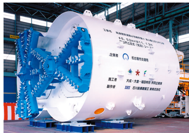
シールド外径: \phi 6.52m \times W11.12m
