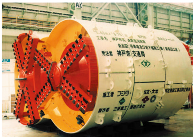
シールド外径: \phi 5.48m \times W9.76m
